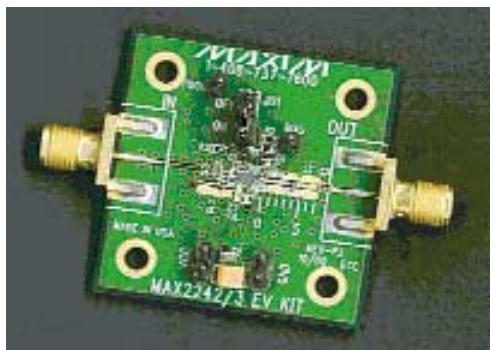
Bild 2: Das EVKit enthält auch alle zum Betrieb notwendigen passiven Komponenten
