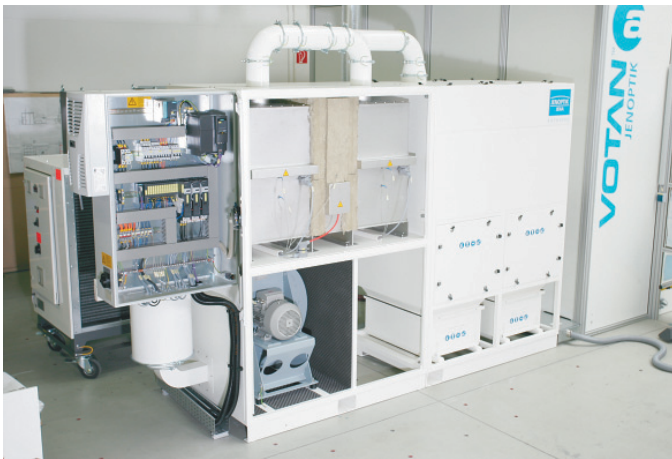
2:Katasorb-Anlage für 1500 m³/h
