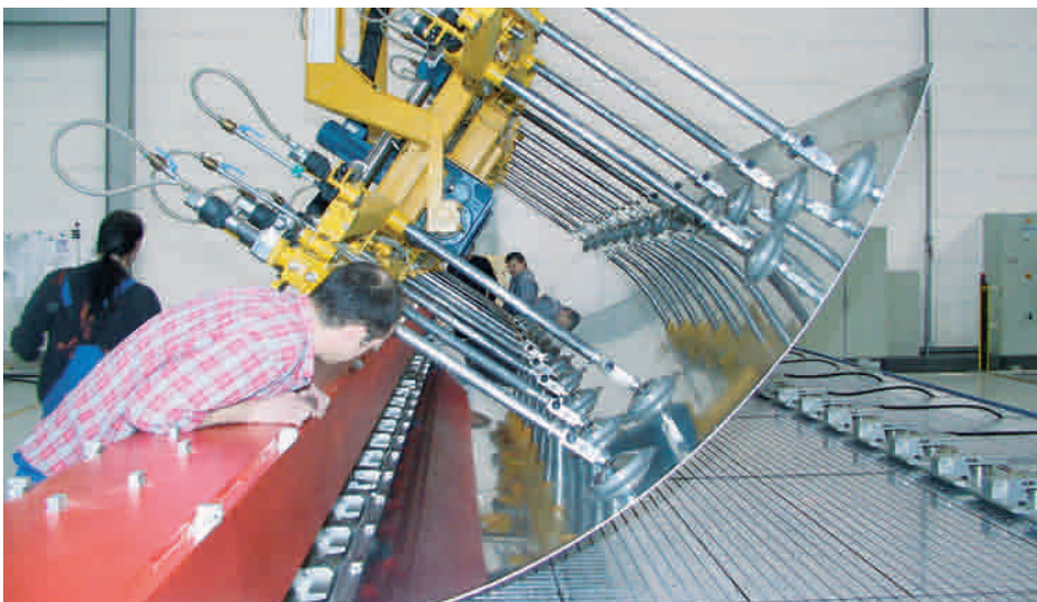
Ein Airbus-Hautfeld wird mittels Lasthebeseystem auf die Spannvorrichtung gehoben und gegen die Anschläge an der Längsseite der Vorrichtung gelegt.
